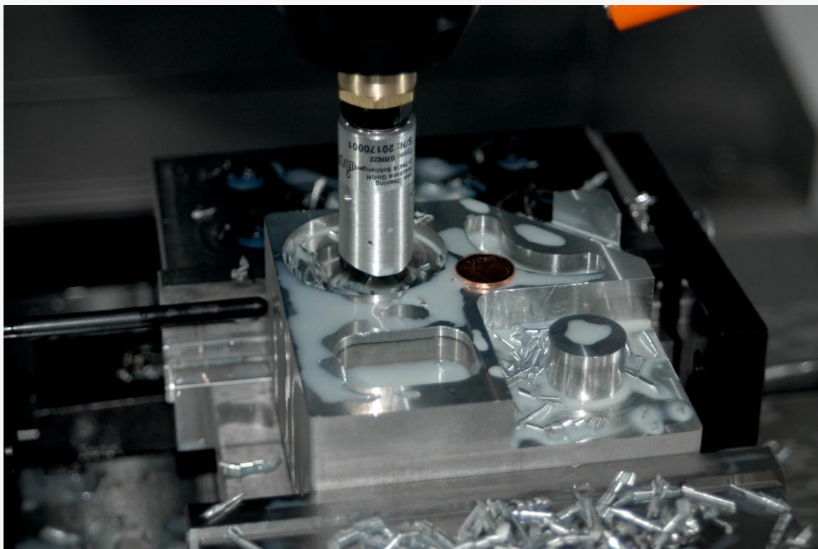
Aplikace: Čištění prostoru při obrábění na CNC obráběcím stroji Application example: Targeted cleaning of a workpiece in a CNC machining center
